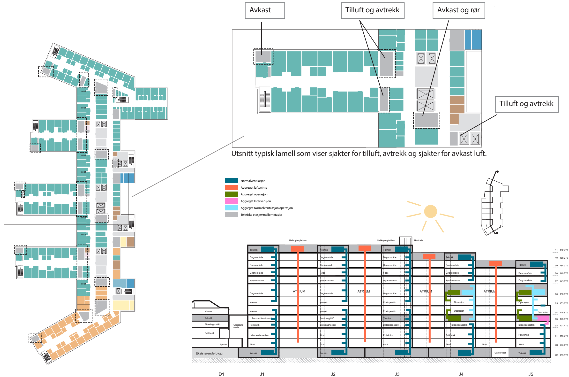
Typisk etasje med sjakter for ventilasjon markert
