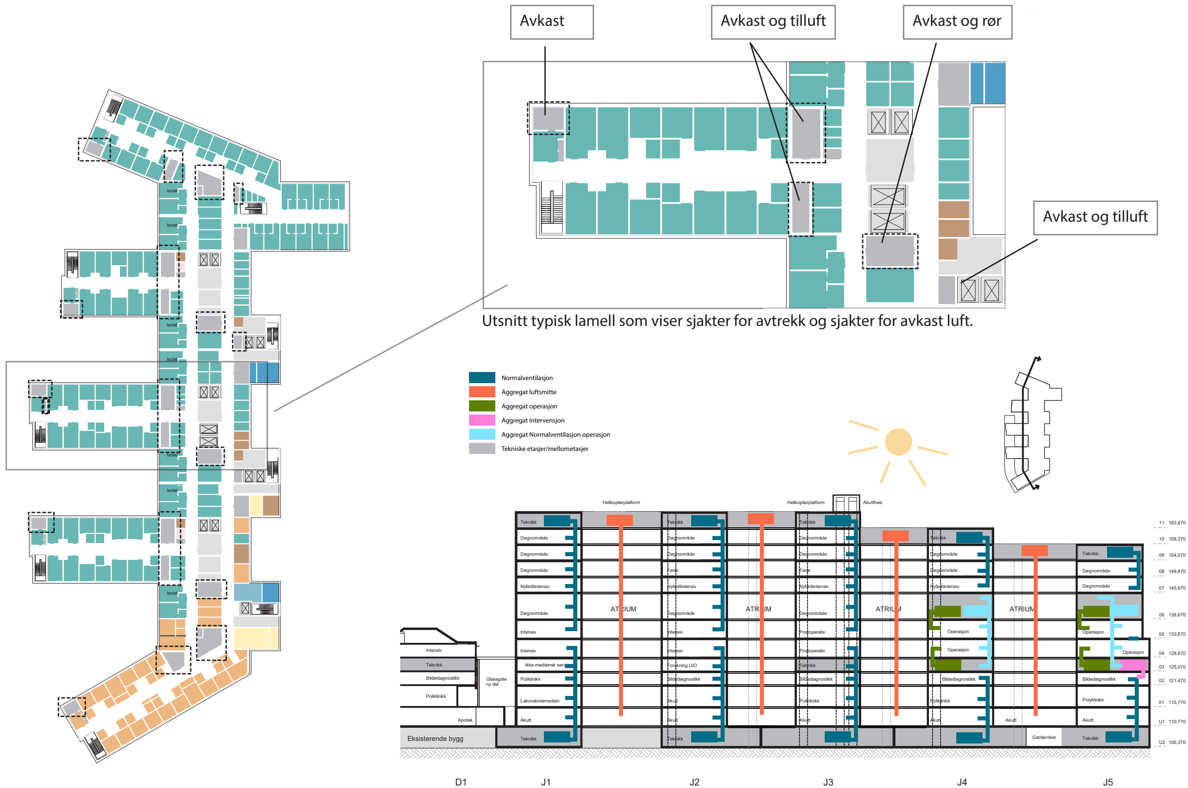
Typisk etasje med sjakter for ventilasjon markert
