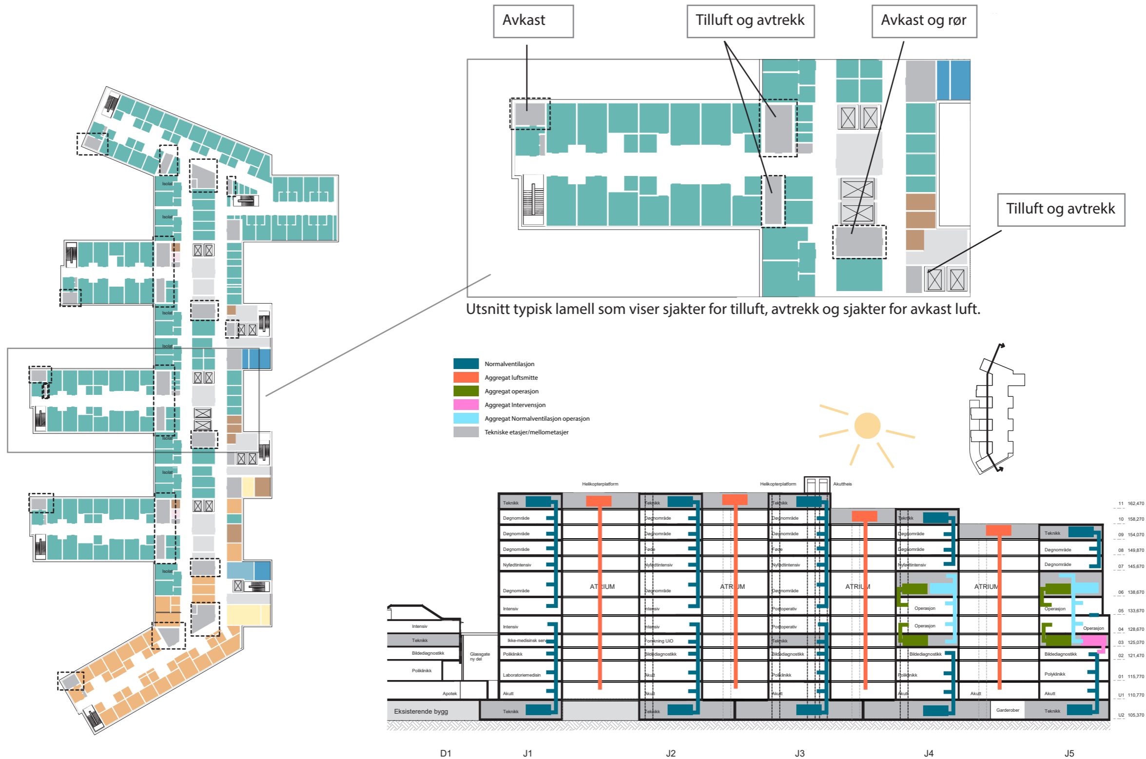
Typisk etasje med sjakter for ventilasjon markert
