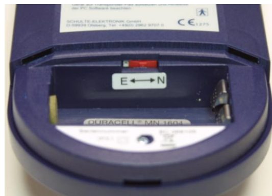
Fig.4: Følsomhetsbryter for respirasjonskanal i batterirommet.
