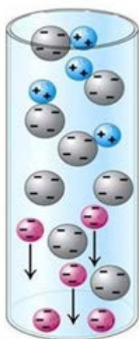
Prinsipp for kationbytter - positiv ladete molekyler har interaksjon med SPE materialet, nøytrale og negativ ladete molekyler eluerer.
